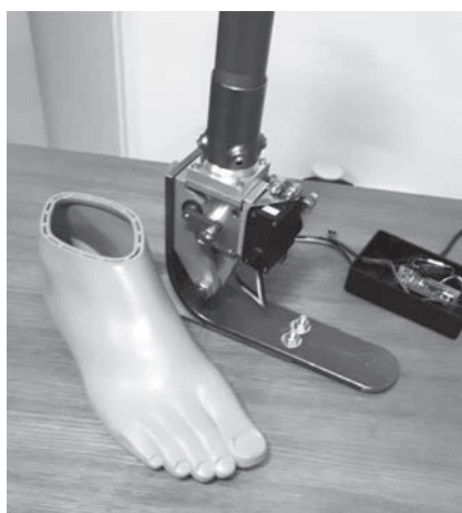
Рис. 8. Искусственная стопа со следящим приводом тыльного сгибания
